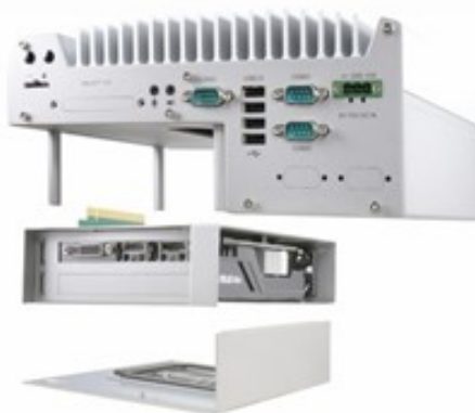
Obr. 2.5: Technológia kazety riadiaceho systému Vision [13]
