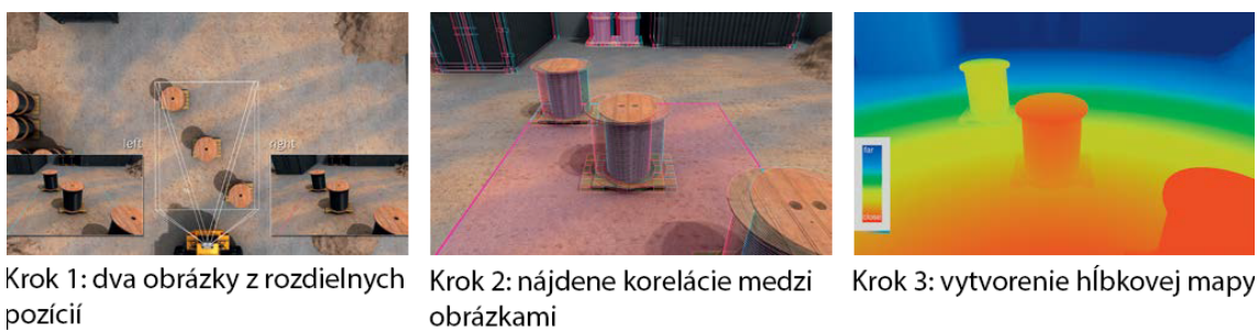
Obr. 1.12: Získanie 3D obrazu metódou priestorového zobrazovania [6].
