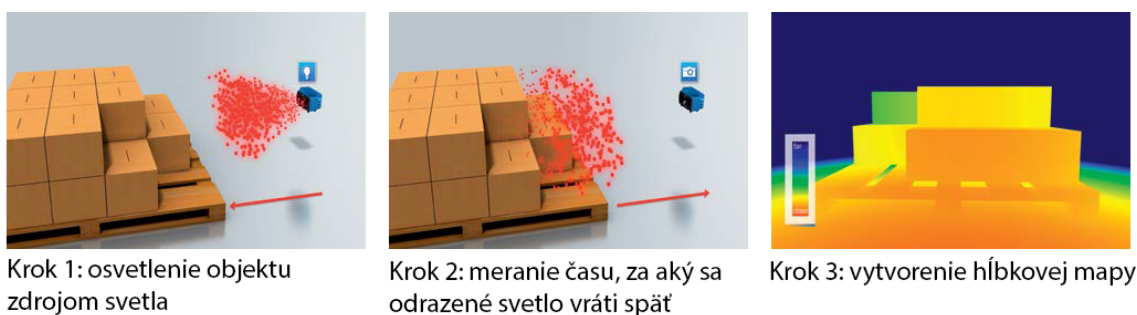
Obr. 1.11: Získanie 3D obrazu metódou doby letu (Time-of-Flight) [6].
