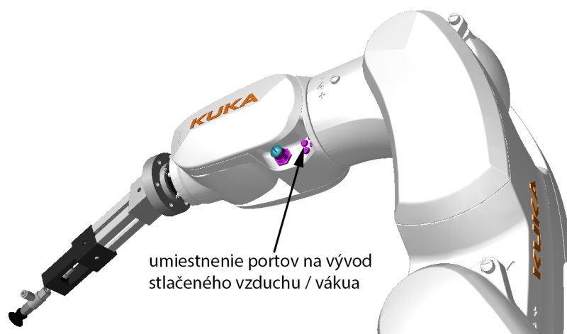
Obr. 3.25: Port rozvodu tlakového vzduchu integrovaný do ramena robota.
