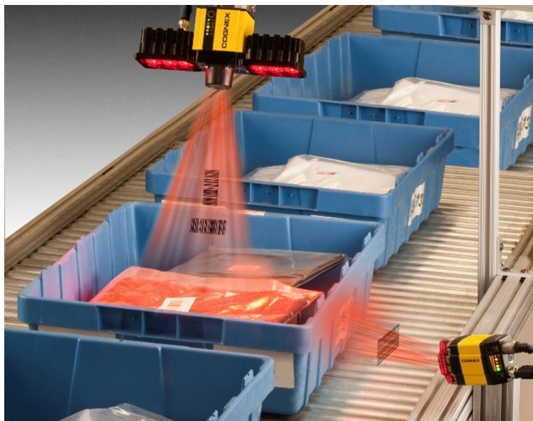
Obr. 1.2: Čítanie čiarových kódov pomocou systému strojového videnia [8].
