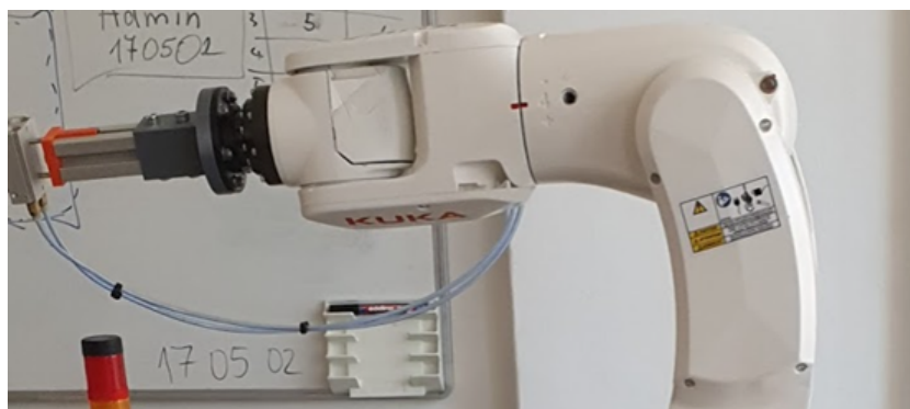
Obr. 3.8: Nastavenie referenčných značiek na kĺbe.
